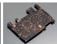
スマートフォン・タブレット用 マザーボード・プリント配線板 (MLB)
